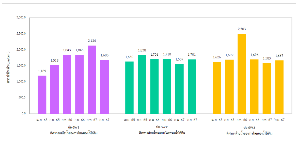
รูปที่ 3-83 เปรียบเทียบความนำไฟฟ้า การติดตามตรวจสอบคุณภาพน้ำใต้ดิน ระหว่างปี พ.ศ. 2565-2567
