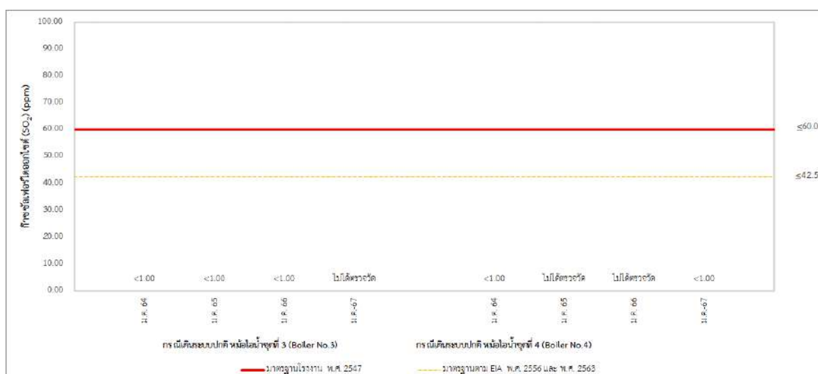
รูปที่ 3-15 เปรียบเทียบผลการติดตามตรวจสอบปริมาณก๊าซซัลเฟอร์ไดออกไซด์ ของปริมาณของสารเจือปนในอากาศที่ระบายออกจากโรงงาน กรณีเดินระบบปกติ บริเวณหม้อไอน้ำชุดที่ 3 (Boiler No.3) และ หม้อไอน้ำชุดที่ 4 (Boiler No.4) ระหว่างปี พ.ศ. 2564-2567
